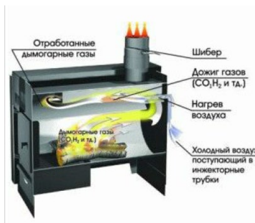
Рис. 2 Устройство газогенераторной печи
