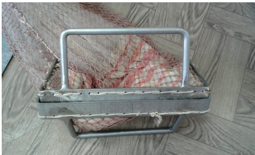
Рис. 3. Общий вид ручного дночерпателя
