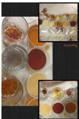
Рис. 7. Определение крахмала в мёде (мёд залили кипятком и капнули туда несколько капель йода)
