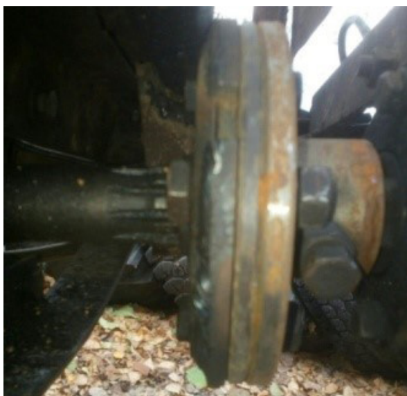
Рис. 5. Вид муфты с чугунным вкладышем и посадкой на валы с натягом
